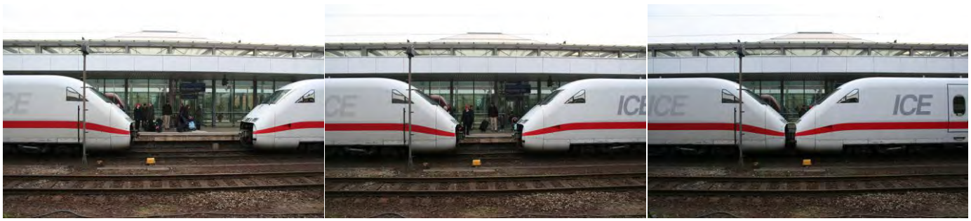
Kuppelvorgang zweier ICE 2-Halbzüge in Hannover Hbf
